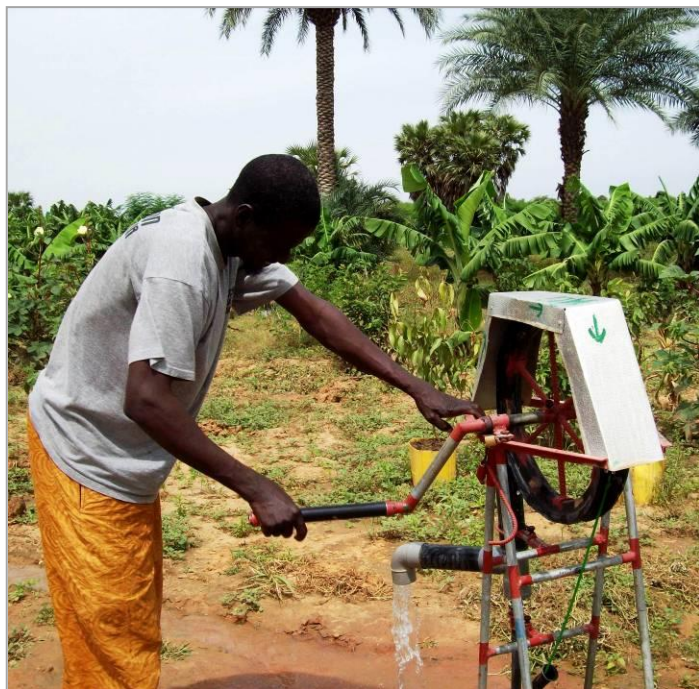
Image 14: Un sondage et pompe construit par Doulos dans la ville de Sélibaby fournit l'irrigation pour la culture des bananes, gombo et les autres fruits et légumes.
